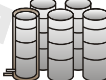
Haubenglühöfen zur Beseitigung der Kaltverfestigung Hood-type annealing furnace to remove strain hardening
